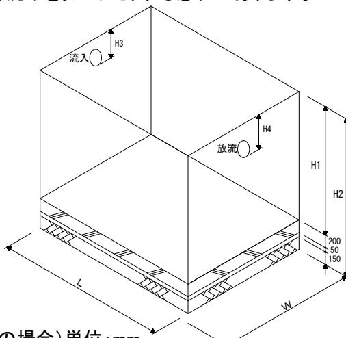
基礎寸法の目安(嵩上げなし、FRP(BMC 製蓋の場合)単位:mm)
