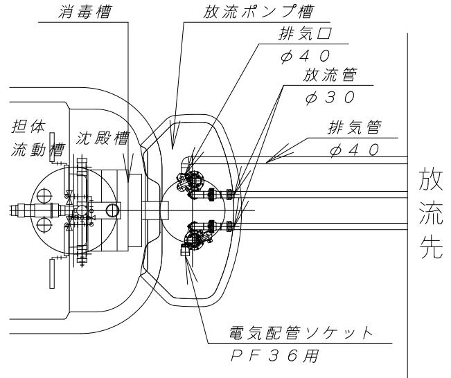
●ポンプ槽の水中ポンプは配送中の破損防止のため、組み付けられていませんので、埋め戻し完了後に同梱の部品を接続してください。
